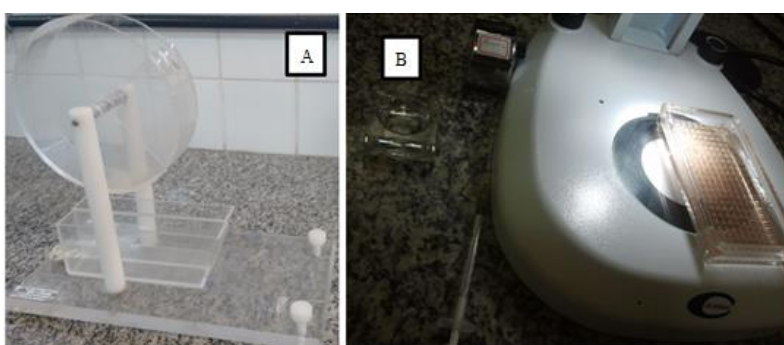
FIGURA 3: A) Quarteador de Folsom; B) Equipamentos utilizados para triagem da nematofauna (Fonte: Lima, 2016)
